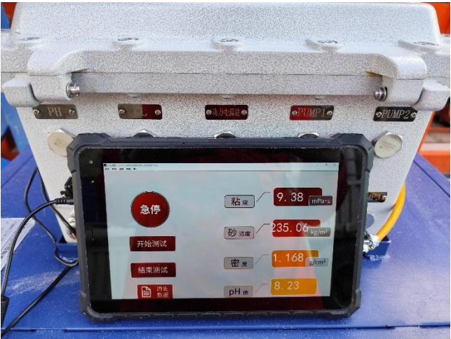
图 1. REALologyFAST 在压裂液在线监测设备的应用
