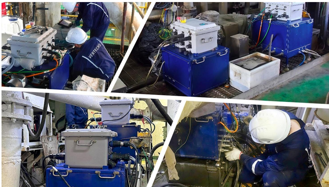
图 1. REALology 智能钻井液性能在线监测系统应用现场
