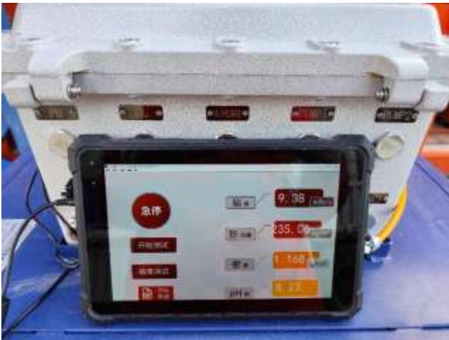
图 1. REALologyFAST 在压裂液在线监测设备的应用
